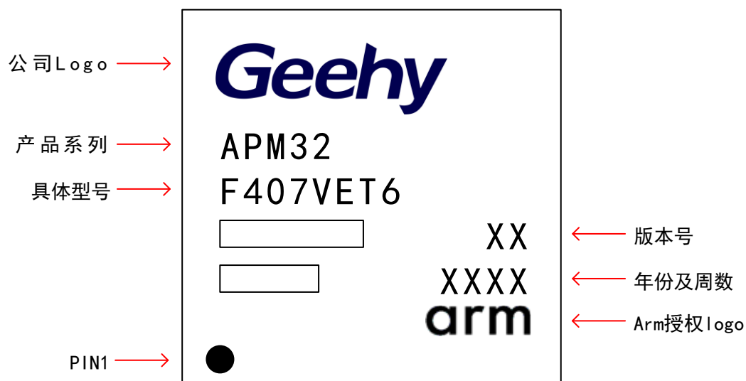
图 25 LQFP100 - 100 引脚, 14 x 14mm 示意图
