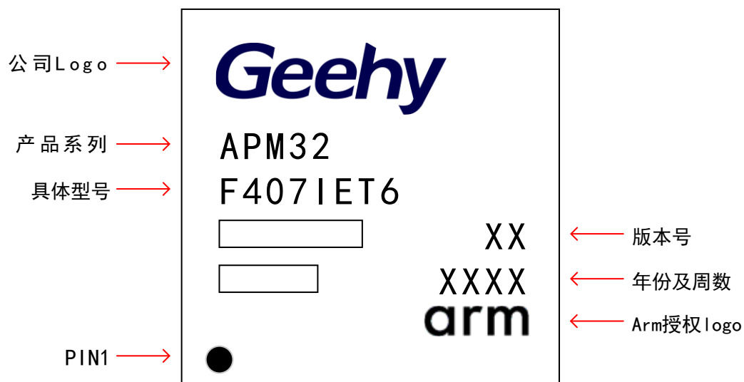
图 19 LQFP176 -176 引脚，24 x24 mm 示意图
