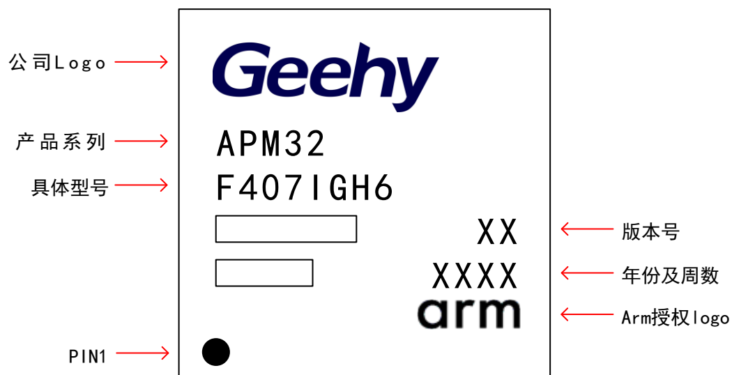
图 31 LQFP64 - 64 引脚，10 x 10mm 示意图
